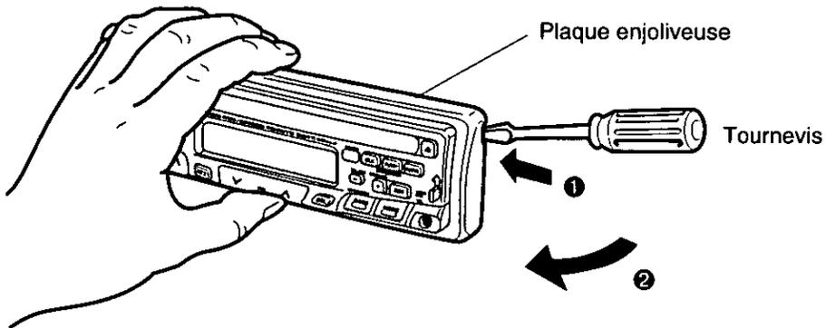
b) Sortir l'appareil en poussant le levier de blocage avec le Tournevis.
